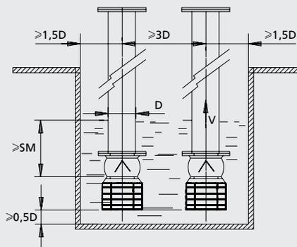
Для предотвращения образования вихрей следует рассчитать минимальную глубину погружения по формуле:
