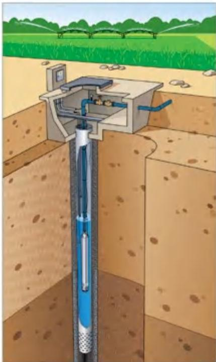
В насосах применяется технология «плавающих» рабочих колес, которая обеспечивает повышенную устойчивость к износу и предотвращает блокировку гидравлики в результате слеживания примеси на горизонтальных поверхностях рабочих колес, что позволяет перекачивать воду, содержащую взвешенные механические примеси\*.
