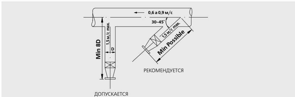
Если диаметр всасывающего отверстия насоса меньше диаметра всасывающего трубопровода, то следует установить эксцентрический конусный диффузор, присоединив его прямым участком к верхней части трубопровода; если же источник снабжения расположен выше насоса, то прямым участком диффузор присоединяется к нижней части.
