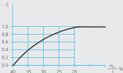
Коэффициент  $C$  выведен опытным путем и зависит от наклона ( $H_m/L$ )
