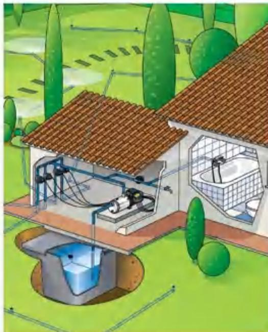
Благодаря наличию встроенного самовсасывающего клапана обладают сильной самовсасывающей способностью, поднимая воду при незаполненном всасывающем трубопроводе на высоту до 9 м\*.
