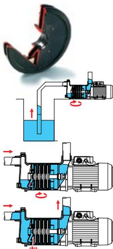
\* Перед началом эксплуатации корпус насоса должен быть полностью заполнен водой. Величина высоты подъема воды приведена для эксплуатации насоса при температуре окружающей среды и перекачиваемой жидкости 20 °C и при нулевой высоте (высоте над уровнем моря). В реальных условиях эксплуатации высота подъема воды насосом может быть меньше.
