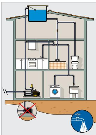
Обладают самовсасывающей способностью, поднимая воду при незаполненном всасывающем трубопроводе на высоту до 2 м\*. При заполненном всасывающем трубопроводе высота подъема воды насосом может составлять до 9 м\*\*.
