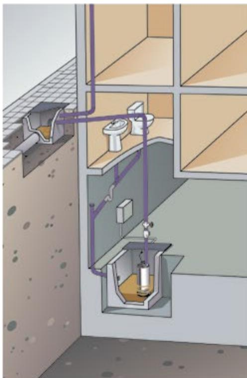
Компактные размеры и небольшой вес насосов серии VIGILA позволяют использовать их в труднодоступных местах и в условиях ограниченности пространства для размещения, как при стационарной установке, так и в качестве переносных дренажных насосов.
